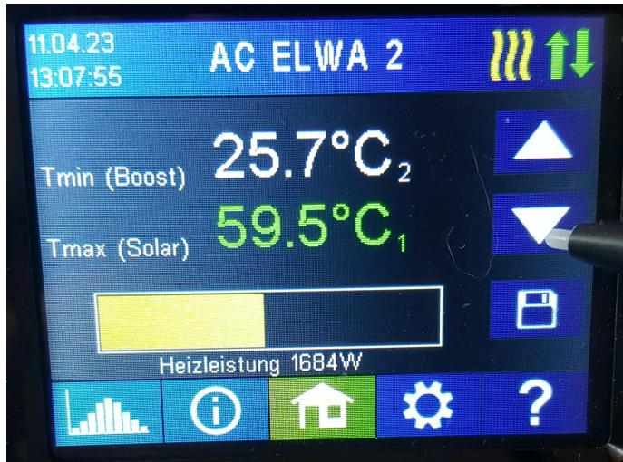
Per impostare la temperatura target per il riscaldamento con eccedenza fotovoltaica, tocca il display inferiore della temperatura Tmax (solare) e utilizza i pulsanti con le frecce su e giù sul bordo destro dello schermo. Salva quindi le impostazioni con il pulsante sottostante.
